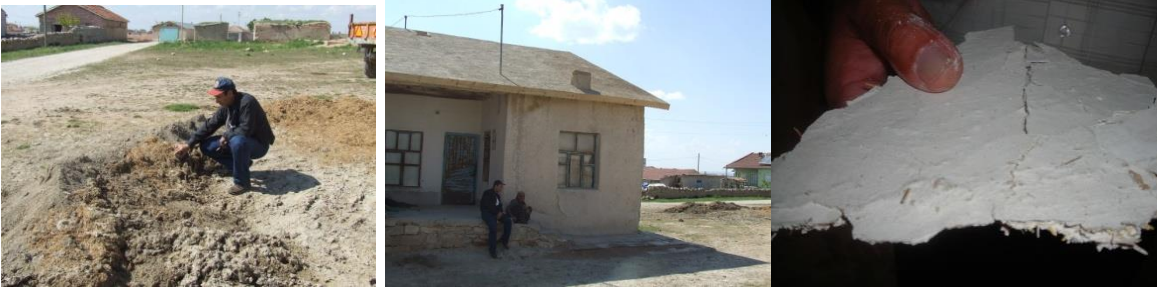
Asbest malzeme, çamur ve kireçli toprakla karıştırılarak harç yapılmakta ve bu harç evlerin damlarında izolasyon maddesi ve sıvasında kullanılmaktadır.
